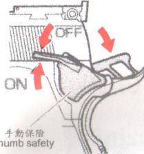
■ 左圖的擊錘只有在「Full Lock」位置時可操作安全裝置在“打開”(ON)的狀態。請勿勉強動作以免破損。
