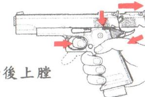
BB彈發射完畢，滑套定位於後方此為無子彈之狀態，如欲繼續射擊填充子彈後下按滑套保險後上膛
