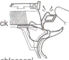
○ Wenn der Schlaghammer sich auf der Position zwischen, voll verschlossen' und, Schlaghammer nach unten' befindet, wird die Pistole halb verschlossen. Auf dieser Position wird die Pistole gesichert.
