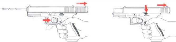
■ 初次裝填彈擊發時需先將滑套後拉使其BB彈上膛，擊扣扳機即可發射
