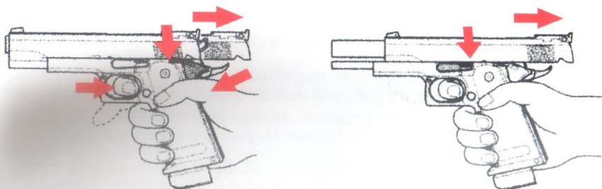
■ 初次裝填彈擊發時需先將滑套後拉使其BB彈上膛，擊扣扳機即可發射
