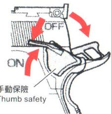
左圖的擊鎚只有在「Full Lock」位置時可操作安全裝置在「打開」(ON)的狀態。請勿勉強動作以免破損。
