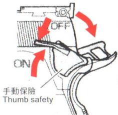
左圖的擊鎚只有在「Full Lock」位置時可操作安全裝置在“打開”(ON)的狀態。請勿勉強動作以免破損。
