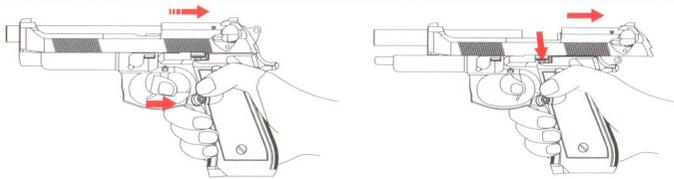
■ 初次裝填彈擊發時需先將滑套後拉使其BB彈上膛，擊扣扳機即可發射
